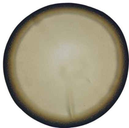
Figura 1. Gota seca de leche entera pura. Se observa una periferia prominente, conocida como anillo de café.
