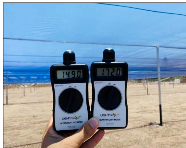
Figura 3. Monitoreo de variables ambientales para la caracterización del microclima bajo malla fotoselectiva. (Fotografía: Autoría propia, material inédito).
