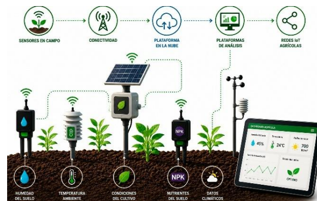
Figura 2. Representación conceptual de un sistema de agricultura inteligente basado en sensores e Internet de las Cosas (IoT, por sus siglas en inglés) para el monitoreo
