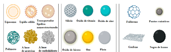
Figura 2. Clasificación de las nanopartículas en función de su composición (modificado de Eker et al., 2024).
