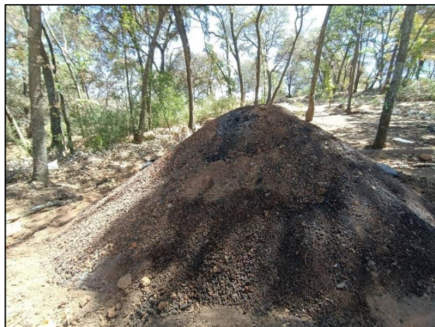
Figura 4. Horno rústico para producción de carbón a partir de madera de encino. Foto: RGM
