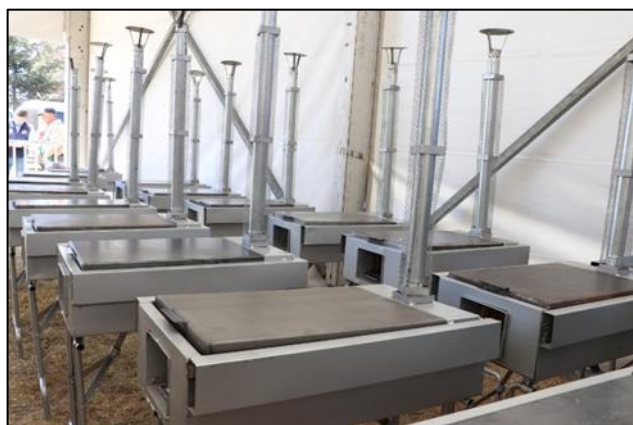
Figura 5. Estufas ecológicas de alta eficiencia térmica a partir de la combustión de leña. Foto: RGM
